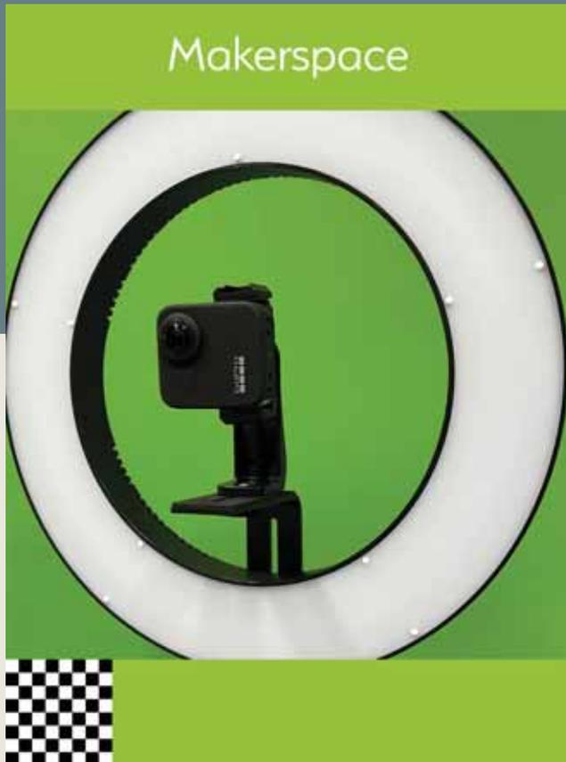
Die Technik des Chroma Keying erlaubt es, einfarbige Hintergründe aus Bildern ganz einfach zu entfernen und auszutauschen. Das Verfahren kann mithilfe des Greenscreen-Pakets ohne großen Aufwand im eigenen Unterricht verwendet werden.
