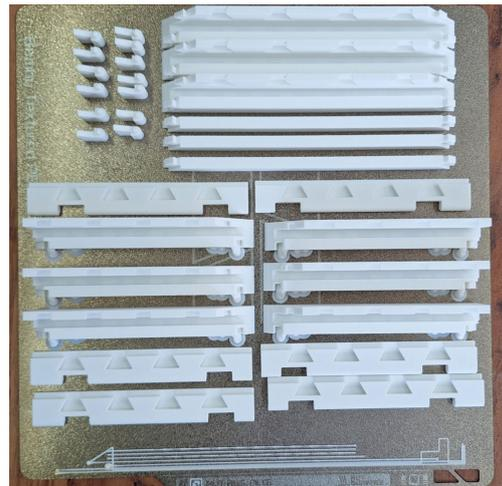
Druckzeit für 1 Set: ca. 3 Stunden, für 3 Sets ca. 7,5 Stunden. Im rechten Bild erkennt man auch die Stützen.
